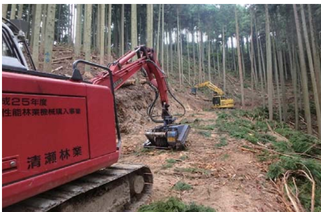
グラブプルとプロセッサによる原木生産システム
