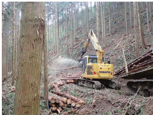
プロセッサによる枝払・玉切状況
