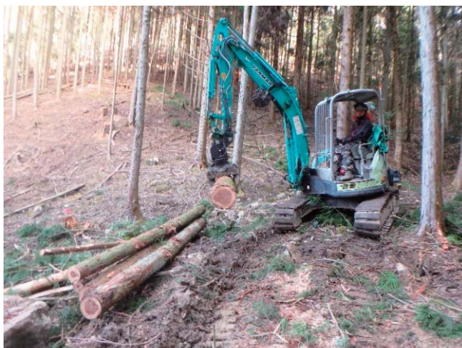
グラップルによる作業状況
