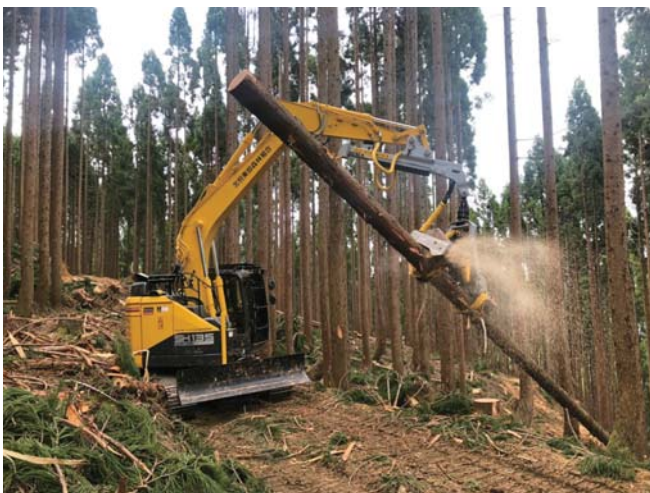
ハーベスタによる造材作業状況
