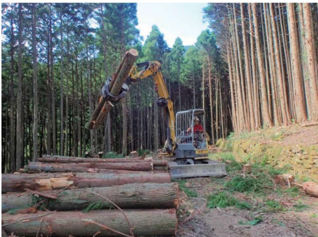
グラップルによる集材作業
