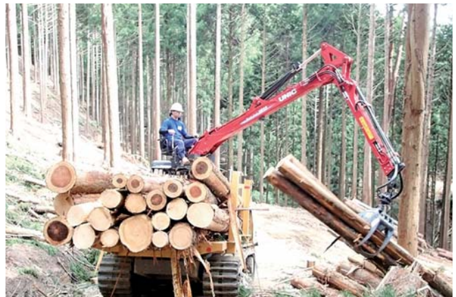
フォワーダによる林内搬出作業
