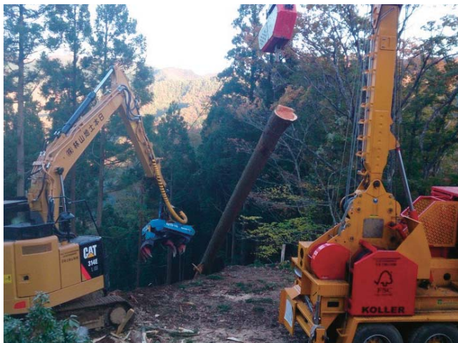
タワーヤーダによる搬出作業
