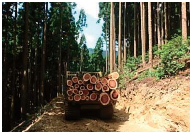
フォワーダによる林内搬出作業
