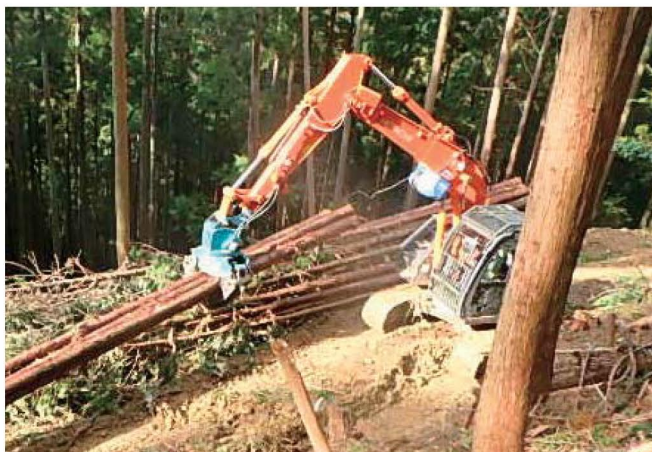
グラップルによる集材作業
