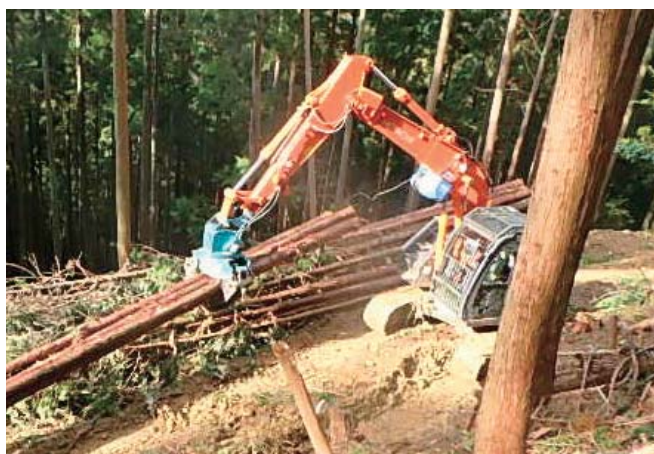
グラップルによる集材作業
