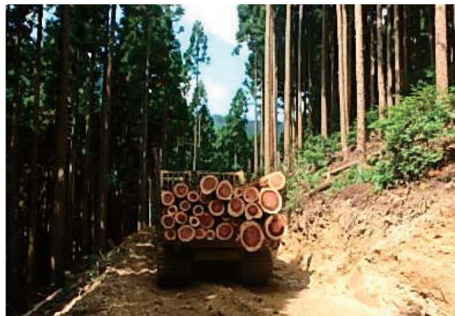
フォワーダによる林内搬出作業
