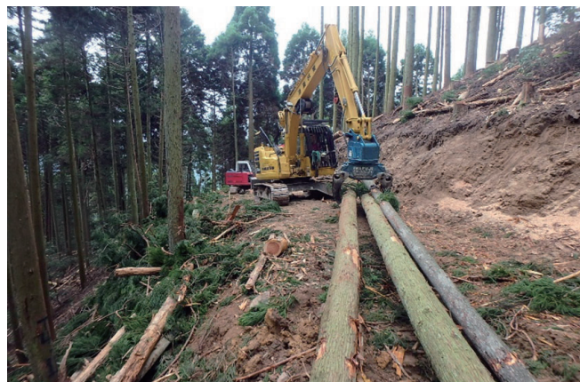
グラブプルによる集材状況
