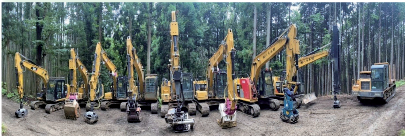
複数の高性能林業機械を連携させた効率的な素材生産
