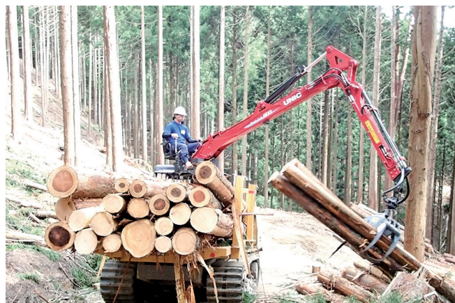
フォワーダによる林内搬出作業
