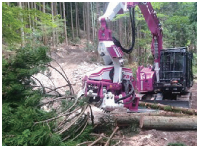
ハーベスタによる造材作業
