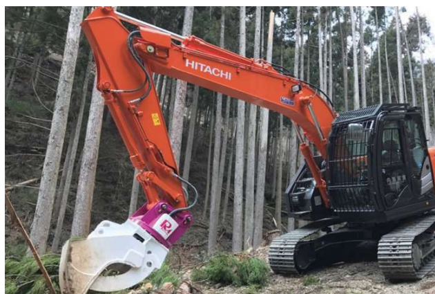
つかみ作業、バケット作業が行えるフェラーバンチャーザウルスロボ
